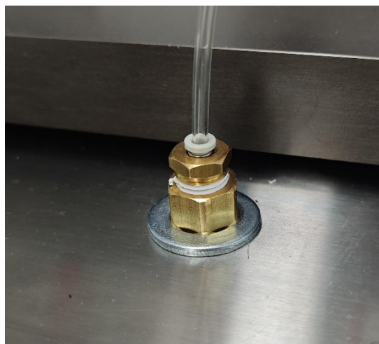
Figura 4: collegamento circuito idro-pneumatico sul piano di lavoro
